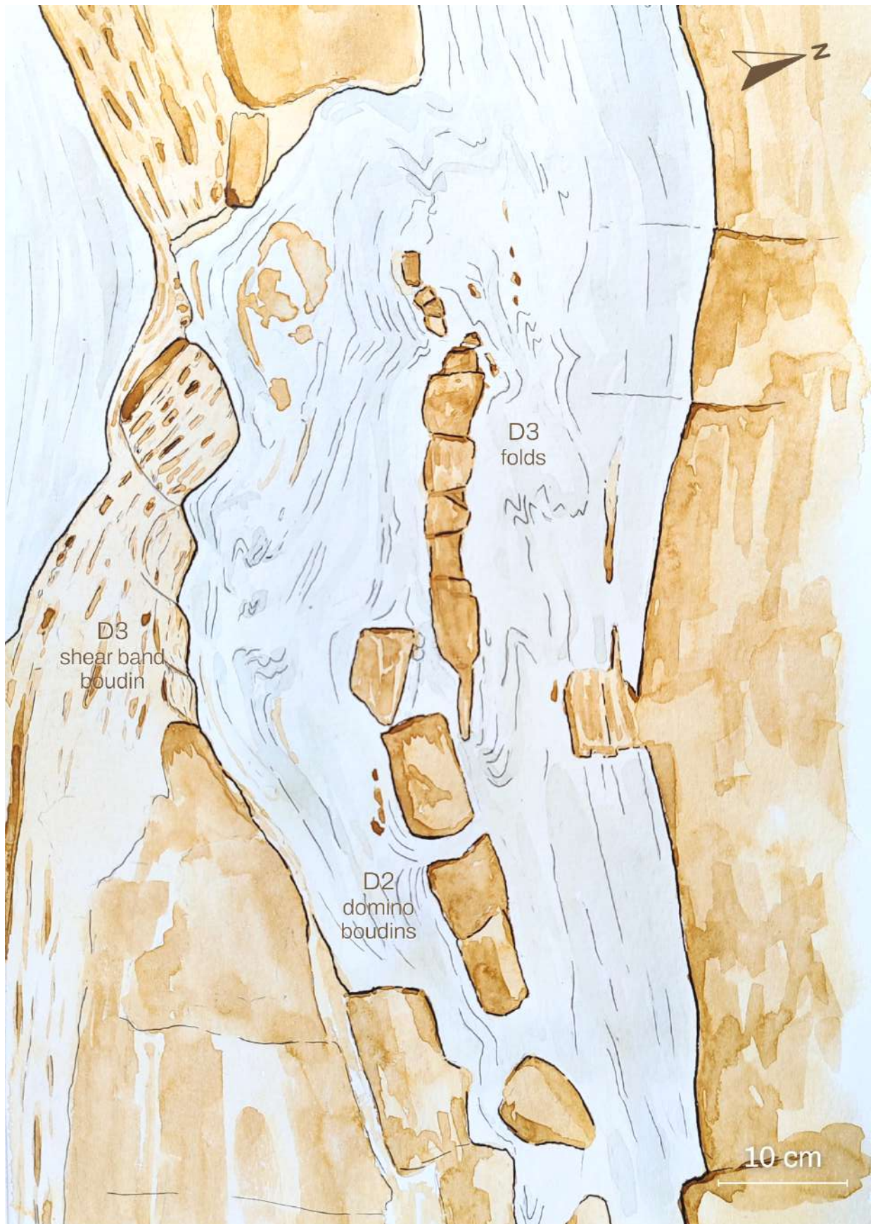
Ilustración gráfica de las estructuras de deformación en boudines. En color gris claro, mármoles cámbricos con comportamiento dúctil y en tonos naranjas y tierra, rocas calcosilicatadas más competentes
